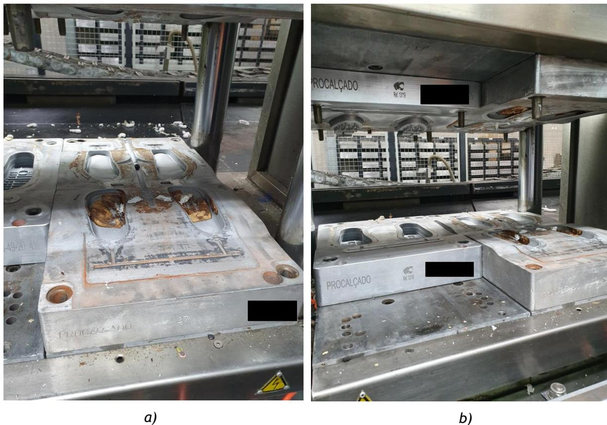
*Figura 8 - a) Parte de baixo do molde de injeção horizontal, onde é possível observar o canal por onde o EVA flui; b) Exemplo de moldes completos.*
