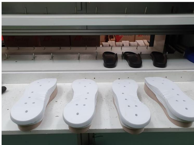
Figura 11 - Pré-formas e estabilizadores utilizados na divisão do EVA
