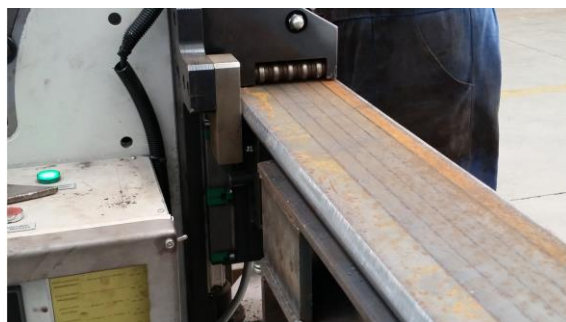
Figura 15: Chanfragem das chapas.
