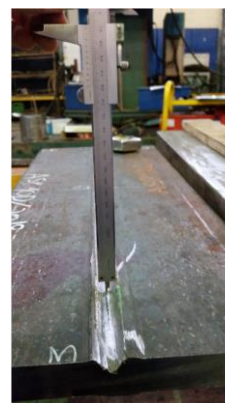
Figura 36: Medição das dimensões da cavidade, com recurso ao paquímetro Mitutoyo .
