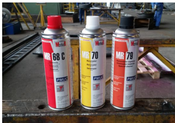
Figura 26: Produtos MarkeR utilizados na inspeção por líquidos penetrantes.
