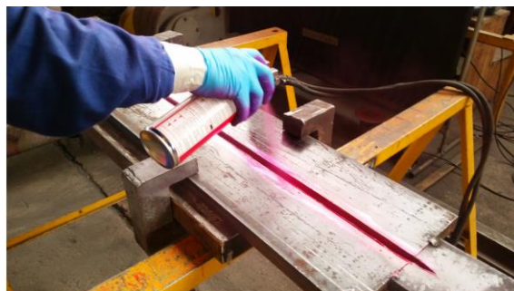
Figura 28: Aplicação do penetrante
