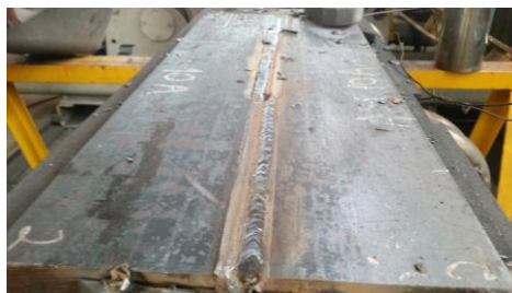
Figura 72: Deposição do 10º passe, 2ª camada.
