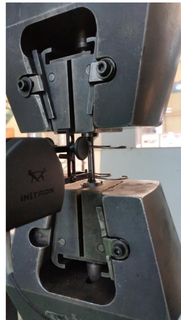
Figura 47: Extensómetro acoplado aos provetes de tração longitudinal.
