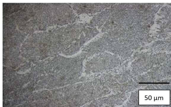
Figura 8: Microestrutura da zona de fusão de um aço ASME 516, soldado utilizando um eletrodo E7018 [51].
