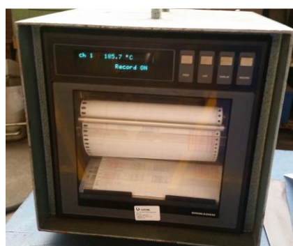
Figura 39: Registo da temperatura da chapa, com recurso a registador Shimaden .
