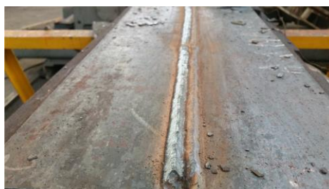
Figura 76: Deposição do 16º passe, 4ª camada.
