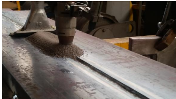
Figura 23: Procedimento SAW, utilizando o equipamento da SAF .
