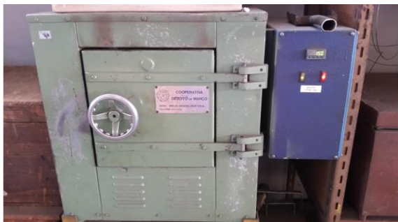
Figura 18: Estufa para armazenamento de consumíveis a 150 °C.
