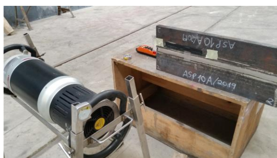
Figura 32: Equipamento YXLON utilizado para a inspeção raio X.
