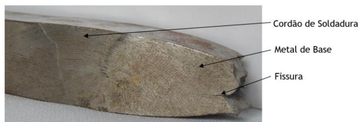
Figura 56: Localização da fissura paralela à direção de tração.
