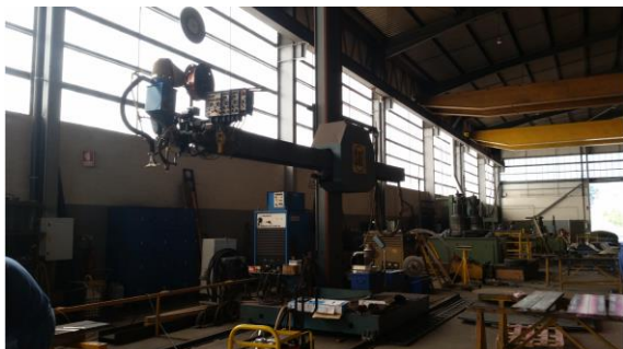
Figura 22: Equipamento SAF , utilizado para a soldadura SAW.
