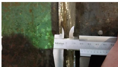
Figura 69: Medição da largura da cavidade, utilizando o paquímetro Mitutoyo.
