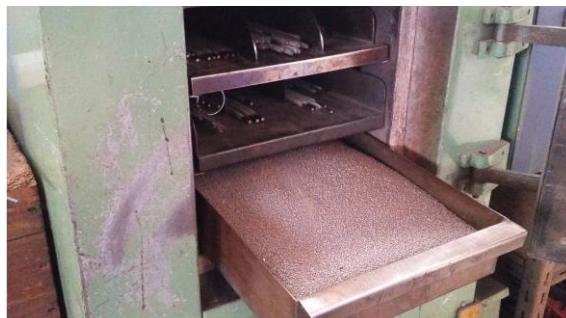
Figura 19: Disposição dos elétrodos e fluxo na estufa.
