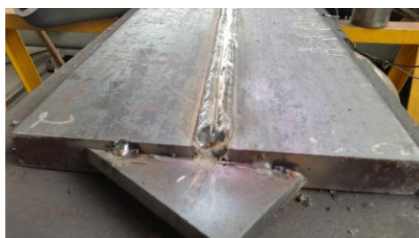
Figura 75: Desbaste da 3ª camada (≈ 1 mm).
