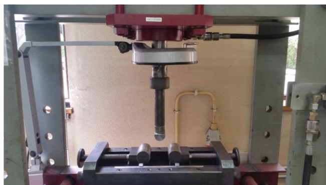
Figura 48: Equipamento utilizado para o ensaio de dobragem lateral (CATIM).
