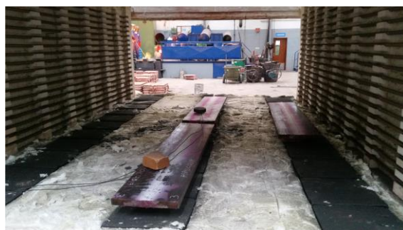
Figura 31: Disposição do material no forno para tratamento de alívio de tensões.
