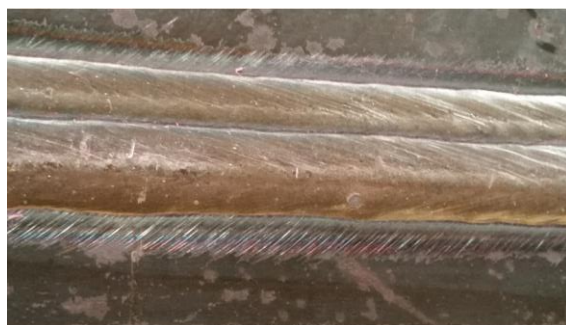
Figura 25: Resultado após o passe final, utilizando o procedimento SAW.
