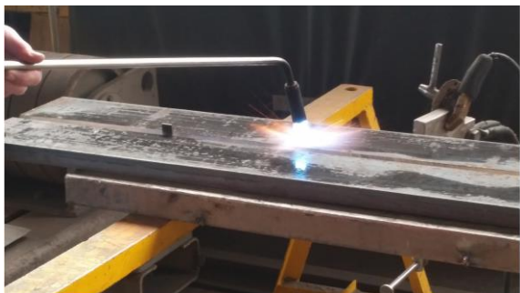
Figura 16: Pré-aquecimento da região a soldar com recurso à tocha oxigás.
