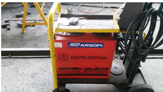
Figura 20: Equipamento KEMPI Pro 4000 da Electro-Portugal , utilizado na soldadura SMAW.
