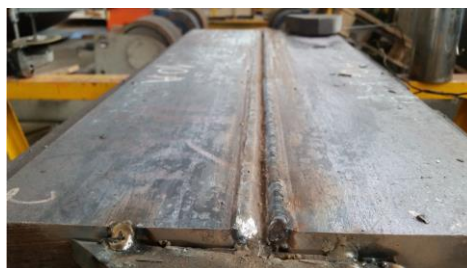
Figura 70: Deposição do 7º passe, 1ª camada.
