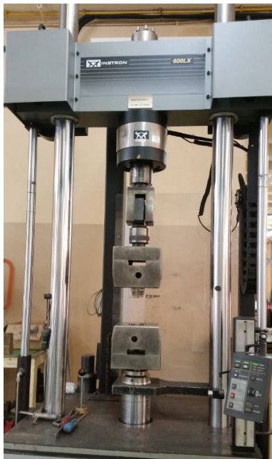
Figura 45: Máquina de tração para provetes transversais prismáticos.
