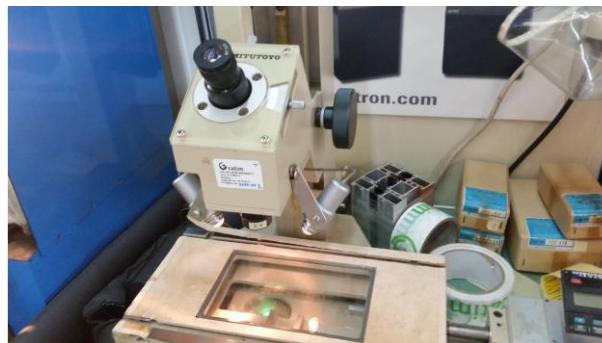
Figura 43: Aparelho Mitutoyo para a medição do raio de curvatura do fundo do entalhe.
