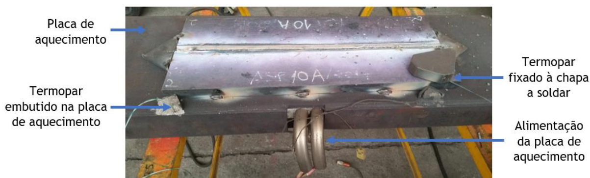
Figura 37: Aparato utilizado para o aquecimento e controlo da temperatura durante o procedimento de Half Temper Bead Welding .
