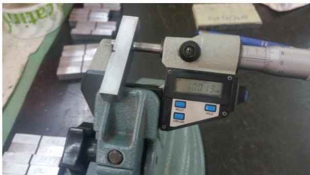
Figura 42: Micrómetro para a medição da largura e espessura do provete.
