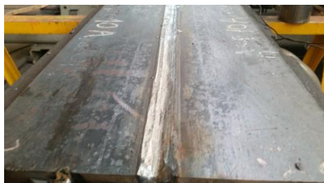
Figura 71: Desbaste da 1ª camada (≈ 2 mm).
