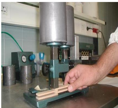
Figura 3.4 Colagem dos provetes.
