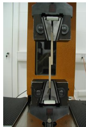
Figura 3.5 Teste de resistência à tração no dinamômetro.
