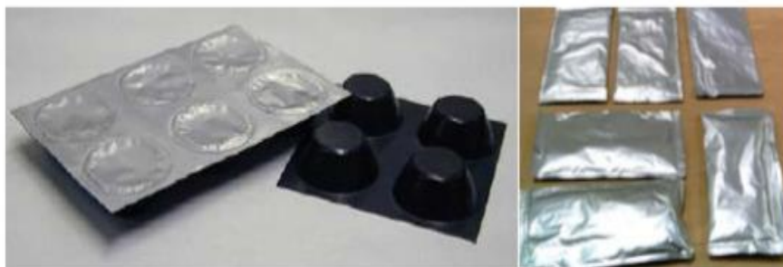
Figura 2.6 - Macrocápsulas de materiais de mudança de fase (Sá, 2012).
