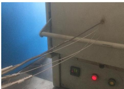
Figura 25 - Introdução dos termopares no interior do forno de mufla.
