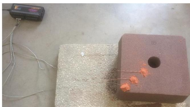
Figura 29 - Instalação dos termopares no interior da cavidade moldante, previamente à realização dos vazamentos.
