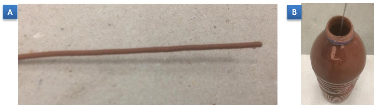
Figura 23 - Ponteira do termopar revestida com uma tinta refratária de zircónia; (A) Ponteira com um filme de tinta uniforme; (B) aplicação do revestimento.
