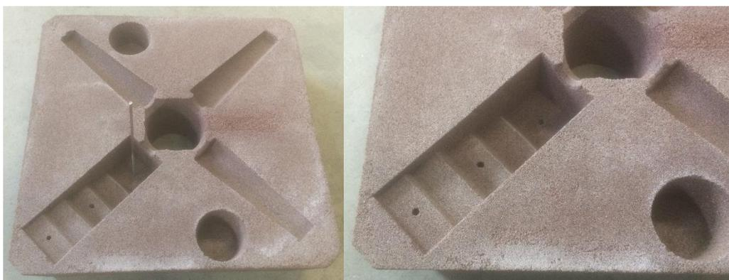
Figura 28 - Criação dos orifícios para instalação dos termopares no interior da cavidade moldante.
