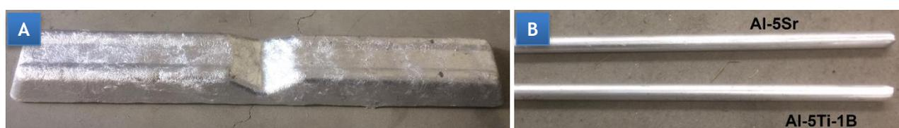
Figura 19 - (A) Exemplo do lingote AlSi7Mg0,3 de fusão primária utilizado na preparação da carga de alumínio; (B) Varetas das ligas mãe Al5Sr e Al5Ti1B utilizadas para os tratamentos do banho metálico.
