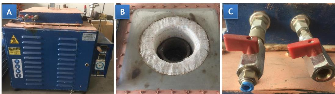
Figura 31 - Forno de fusão de alumínio do departamento; (A) Visão geral do equipamento; (B) Câmara de fusão contendo um cadinho com 3,5 kg de capacidade de carga; (C) Válvulas de admissão de gás.
