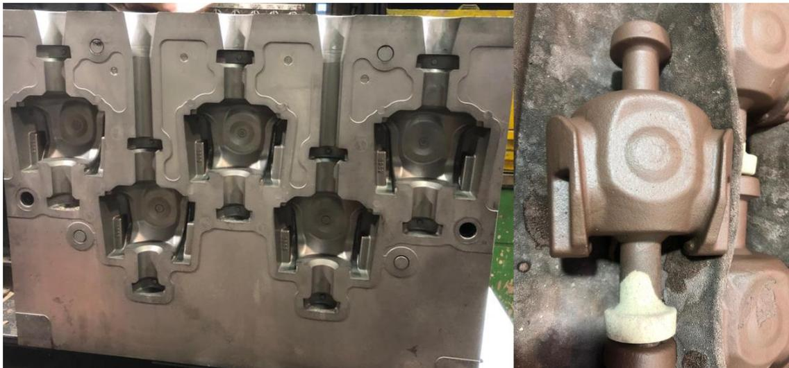
Figura 7 – Caixa de macho utilizada na produção desta referência e respetivo macho.
