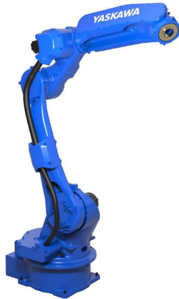
Figura 13. Robô Yaskawa Motoman GP25 [12].
