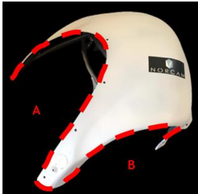
Figura 12. Estratégia de perfilagem criada para comparação entre os métodos de programação.
