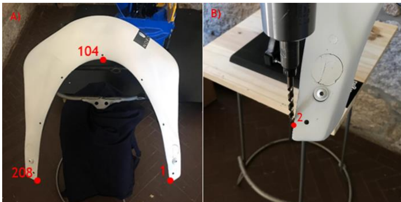
Figura 16. Exemplo de alguns pontos memorizados na programação online realizada na zona A.
