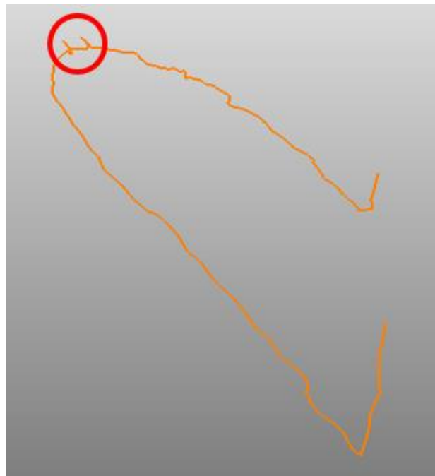
Figura 44. Exemplo de erro ao criar o percurso devido à falta de atrito entre a ponteira e a carenagem.
