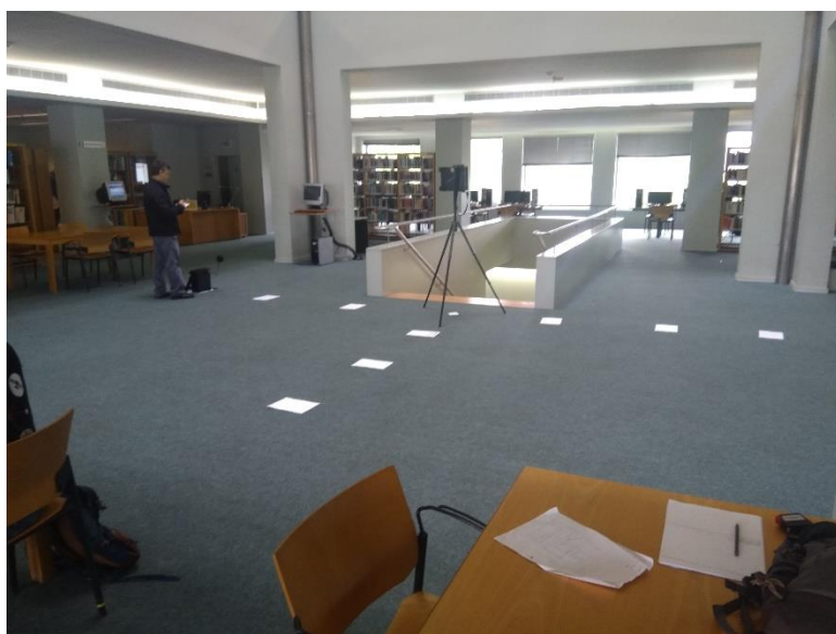
Fig. 33 – Medição “in situ” do índice RASTI.
