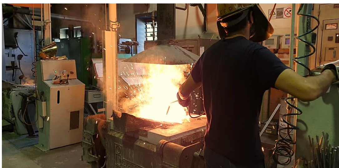
Figura 23 - Medição da temperatura do banho com um termopar.
