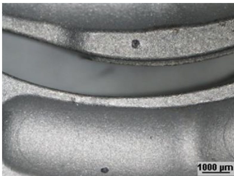
Figura 19 - Exemplo da existência de poros em duas peças do componente em estudo.
