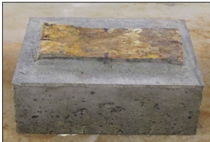
Fig. 26 - Encapsulamento da metade inferior de uma amostra de ensaio de formato retangular (Muralha et al. 2014, Fig. 3)
