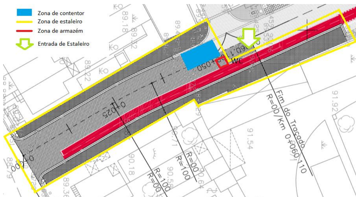
Fig.3.7. – Esquema 2 com zona estaleiro e escritório adaptado da planta original cedida por [19]
