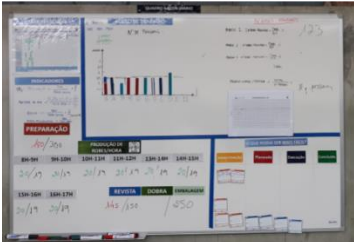
Figura 27- Quadro de Kaizen Diário da equipa de confeção de robes
