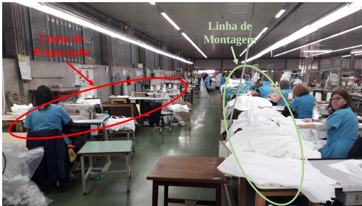
Figura 15-Disposição do Layout: linha de preparação e linha de montagem
