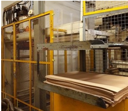
(a) Aplicação de acrílico para garantir melhor visibilidade do manipulador.
