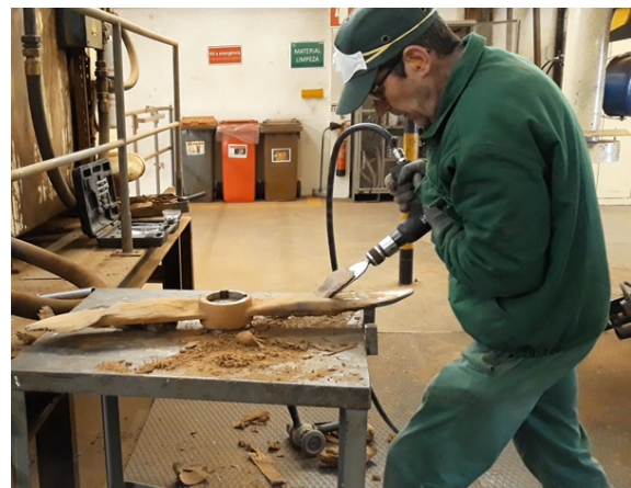
(b) Limpeza de pás do misturador com ferramenta pneumática.
