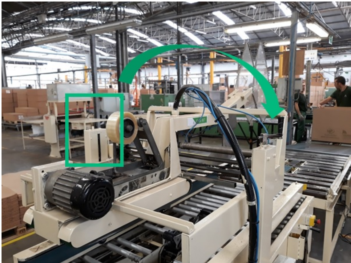
Figura D.5: Alteração da posição de um manipulador da linha de embalagem.
