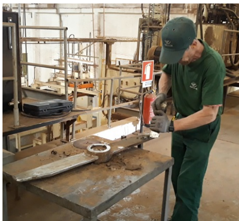
(a) Limpeza de pás do misturador com ferramenta manual.
