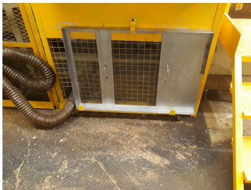
(a) Nova ferramenta para recolha de granulado remanescente no sistema.
