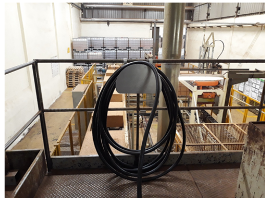
(b) Substituição por mangueira com maior caudal de ar comprimido expelido.
