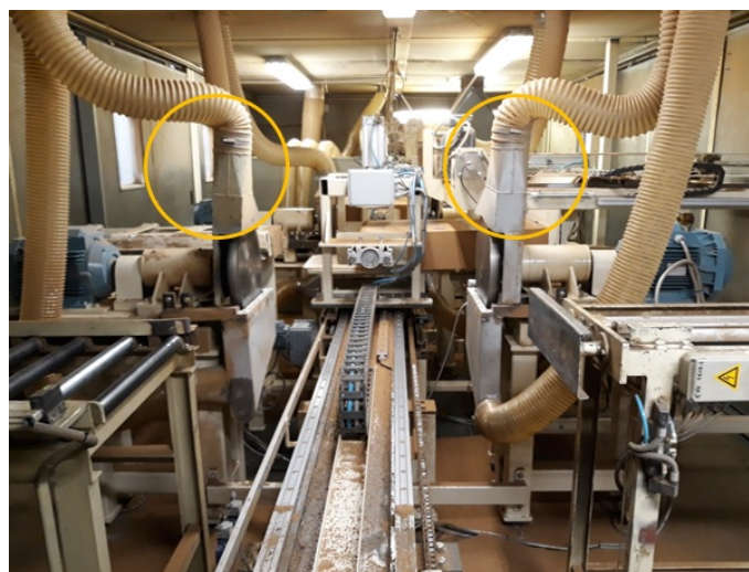
Figura 4.13: Retificadora de blocos. A amarelo encontram-se assinaladas as porções superiores das campânulas.
