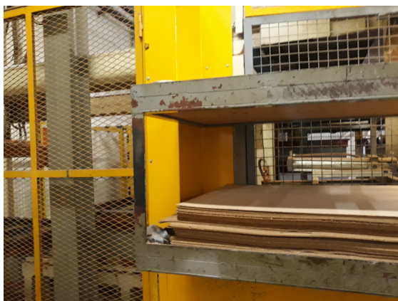
(c) Chapa opaca impedia a visibilidade do sistema de elevação de moldes.
