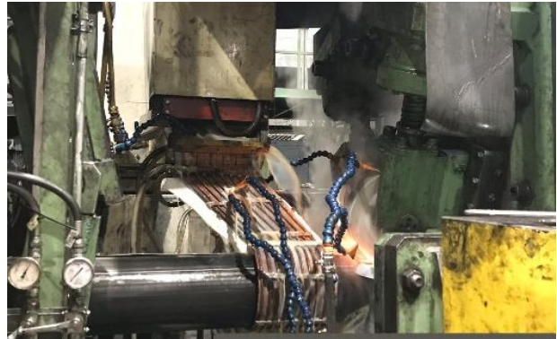
Figura 14: Aplicação do ponto de soldadura
