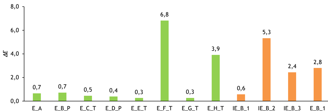
Figura 4.3 - Diferença de cor registada após limpeza húmida das películas de tinta sujeitas ao ensaio da resistência às cinzas.
