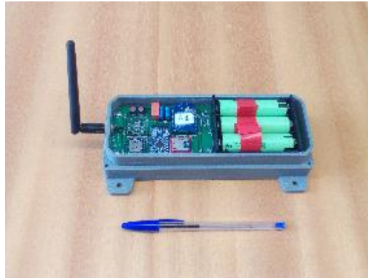
Figura 3.4 - Sensores com 6 meses de autonomia "Portátil 3"(Moutinho e Cunha 2019)
