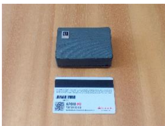
Figura 3.3 - Sensores com 15 dias de autonomia "Portátil 3"(Moutinho e Cunha 2019)
