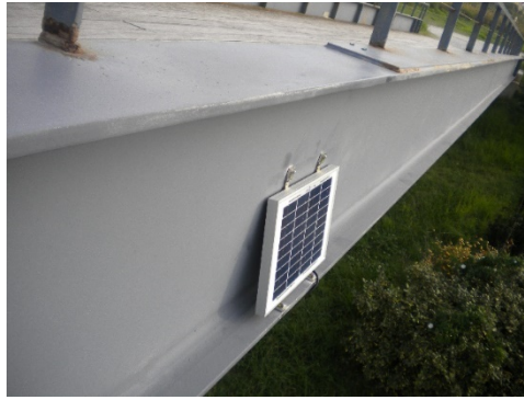
Figura 3.8 - Sensor "Solar 1" na Ponte pedonal do Edifício Transparente (Moutinho e Cunha 2019)
