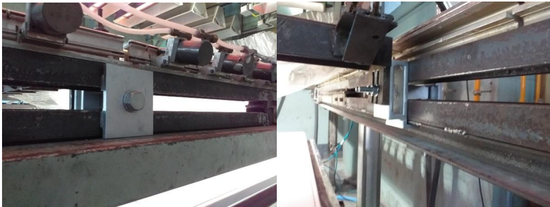
Figura 31 - Aperto rápido da máquina de termoformação
