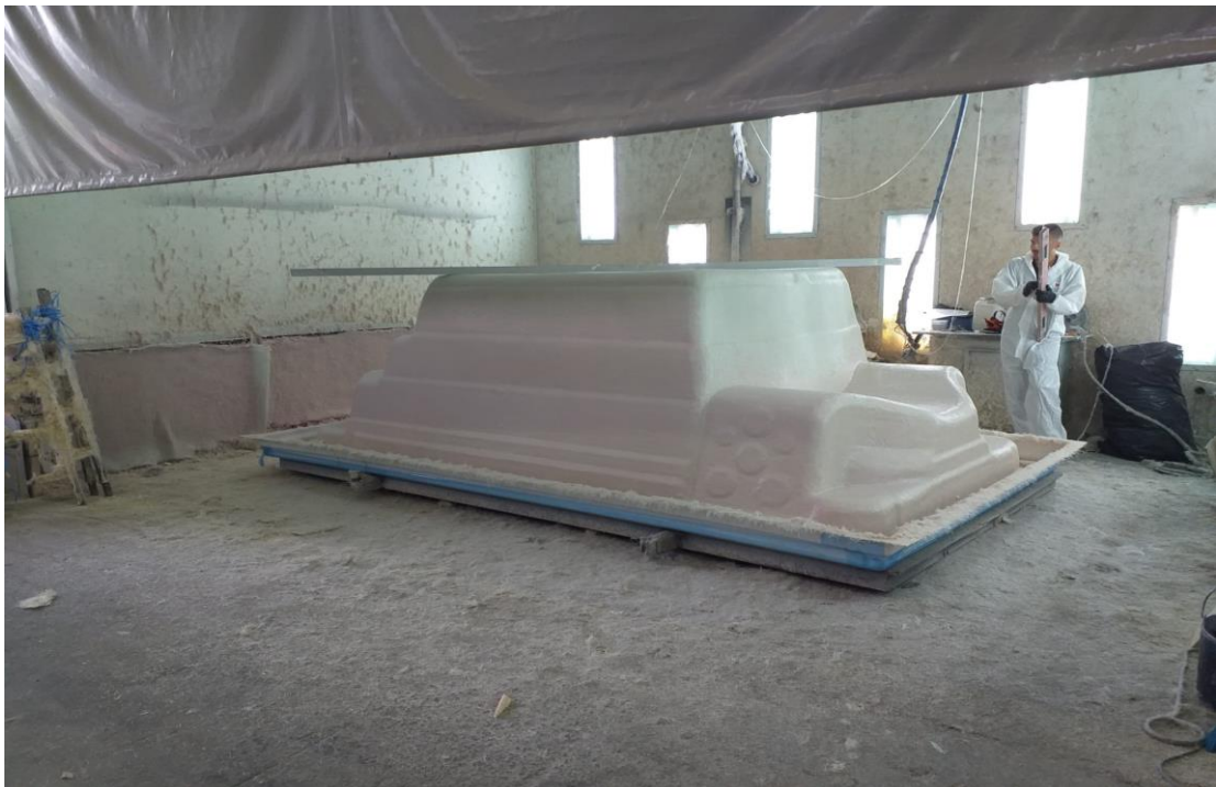
Figura 35 - Fibragem de Swimmer na linha das Swimmers
