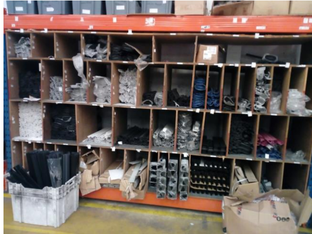
Figura 16 - Exemplo de um supermercado FILO e material em excesso no chão
