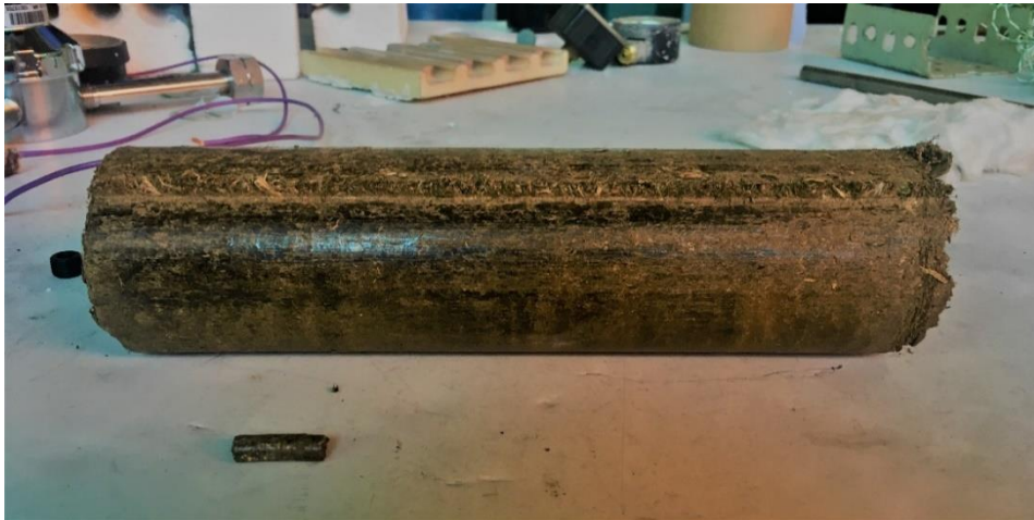
Figura 3.1 - Comparação das dimensões dos briquetes com as dos péletes. Combustíveis utilizadas em ensaios de combustão do INEGI.
