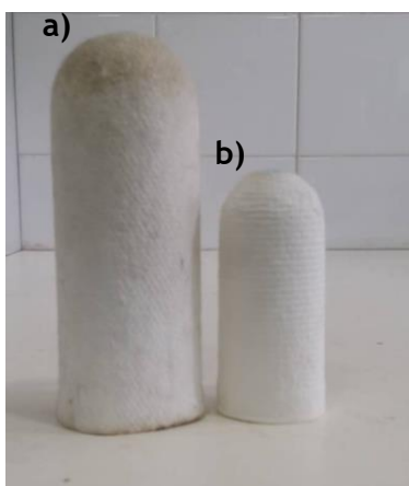
Figura 6 - Cartucho de celulose utilizado no: a) Soxhlet e b) Soxtec.
