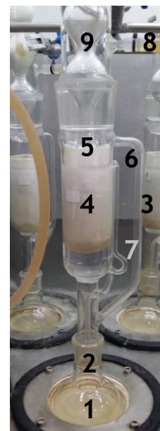
Figura 9 - Extração da gordura de uma amostra de pelo utilizando o extrator Soxhlet.
