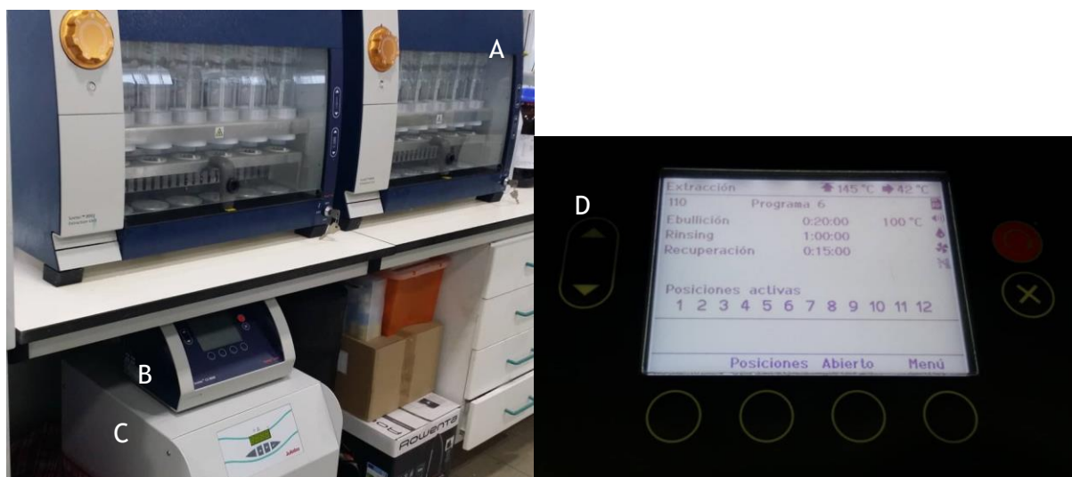
Figura 10 -A - Duas Unidades de Extração (UE); B - Unidade de Controlo (UC); C - Chiller Julabo F1000; D - Ecrã da UC com os parâmetros definidos e posições ativas.
