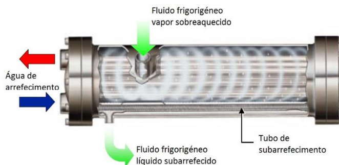
Figura 2.10 - Condensador arrefecido a água, adaptado de [11].
