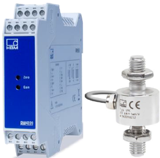
Figura 4.5: Celula de Carga da HBM e respetivas especificações [41].
