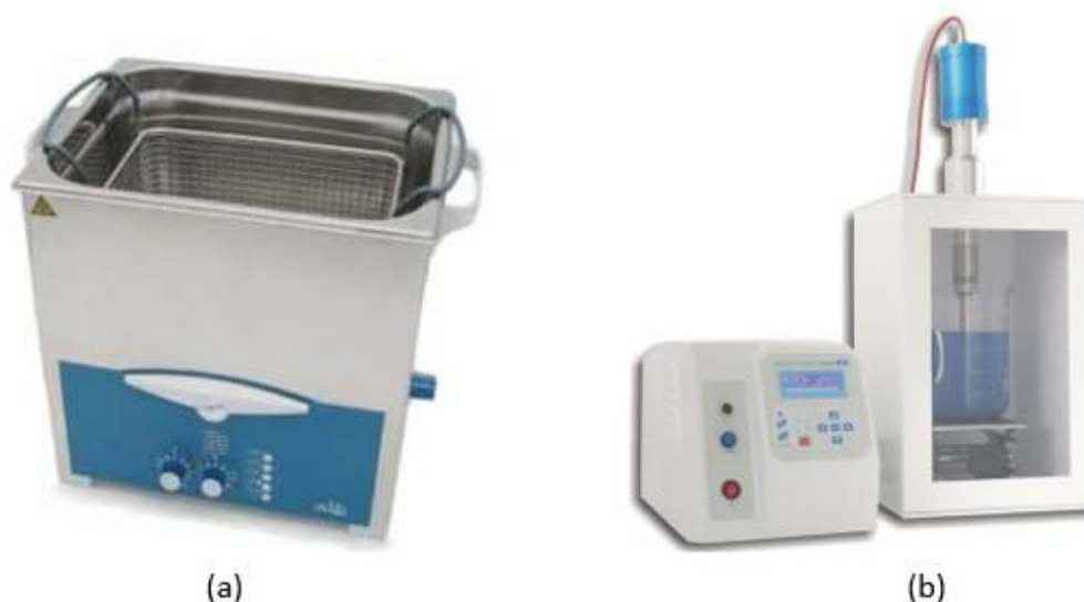
Figura 37 - Equipamento de ultrassons por banho (a) e por resina (b) [90], [91].
