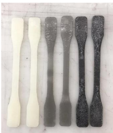
Figura 55 - Imperfeições presentes na área de contacto dos provetes com o molde. Nota-se um agravamento das mesmas nos provetes de 0,05% de fração mássica de SWCNT.
