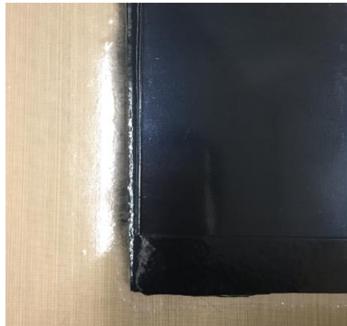
Figura 63 - Presença de nanotubos de carbono no excesso de resina.
