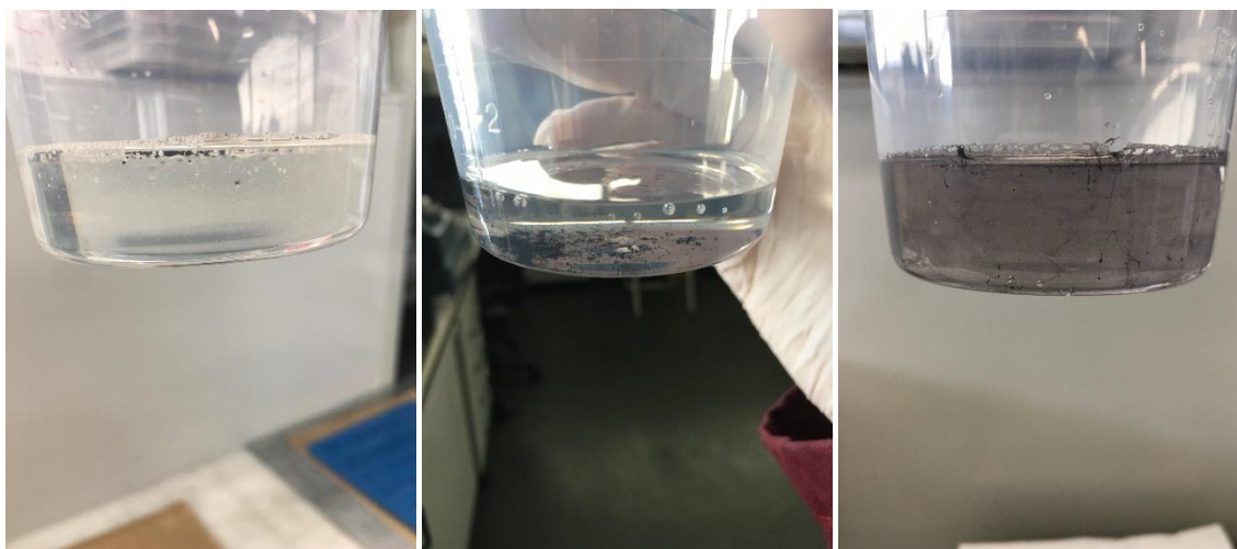
Figura 42 - Evolução da dispersão dos nanotubos de carbono com o tempo de utilização de ultrassons. À esquerda, sem qualquer tempo de utilização, ao centro após uma utilização de 30 minutos e, à direita, após uma utilização de 60 minutos.
