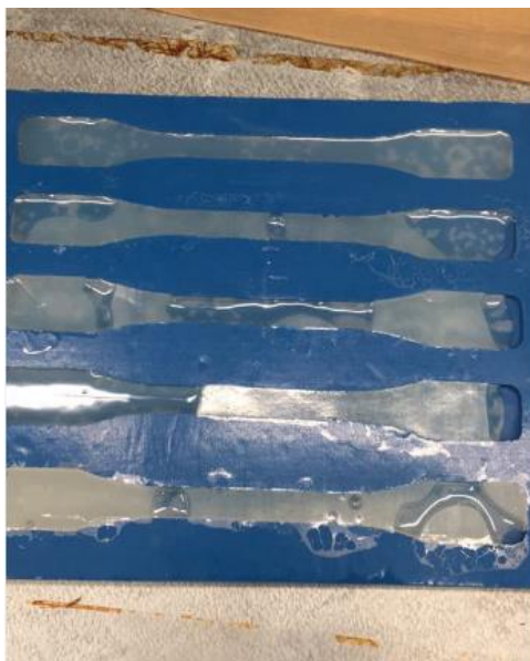
Figura 49 – Primeiros provetes referência inseridos no molde, após a cura em estufa.
