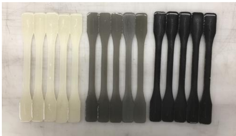
Figura 54 - Provetes dogbone produzidos com três diferentes frações mássicas de SWCNT. À esquerda, provetes referência, ao centro, provetes com 0,01% e, à direita, provetes com 0,05%.
