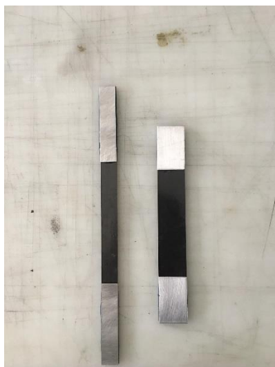
Figura 69 - Provete reforçados com fibra de carbono, após a colagem dos "tabs".
