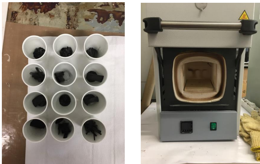
Figura 66 - Processo de calcinação na mufla: (a) Cadinhos com fibra de carbono após a calcinação da resina; (b) Mufla presente nas instalações do INEGI.
