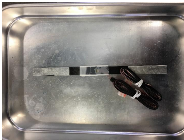
Figura 71 - Exemplo de um provete com extensómetro, após colagem.
