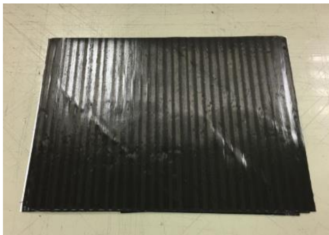
Figura 59 - Laminado após o empilhamento das camadas.
