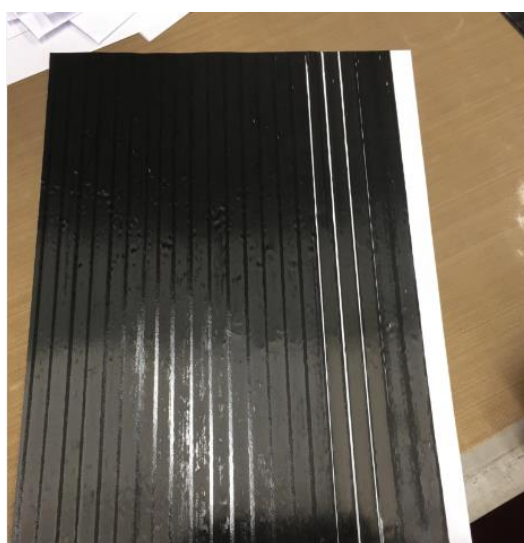
Figura 58 – Presença de um gap significativo num prepreg produzido (a rejeitar).
