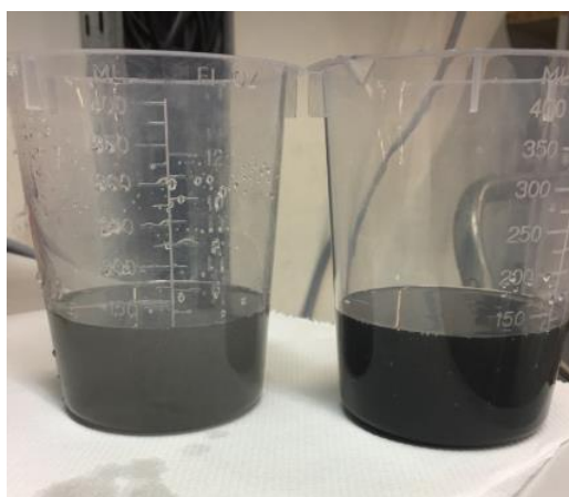
Figura 47 - Evolução da cor da mistura de resina e 0,05% de CNT. À esquerda, a mistura antes da passagem na máquina de três rolos e, à direita, após a passagem.
