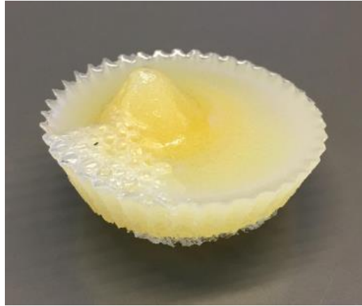
Figura 36 - Amostra de resina e endurecedor KTA 315. É visível, apesar de reduzida, a ocorrência de uma reação exotérmica prejudicial no material.
