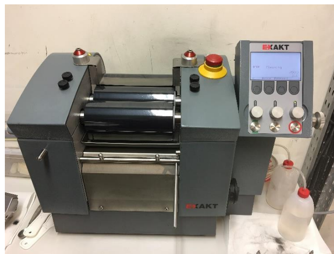
Figura 25 - Equipamento de três rolos presente nas instalações do INEGI.
