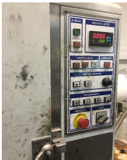
Figura 50 - Controlador da máquina de desgaseificação presente nas instalações do INEGI. No canto superior direito é visível o indicador de vácuo.
