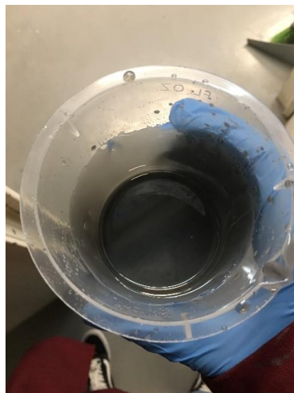
Figura 53 - Mistura de resina e CNT após degaseificação.
