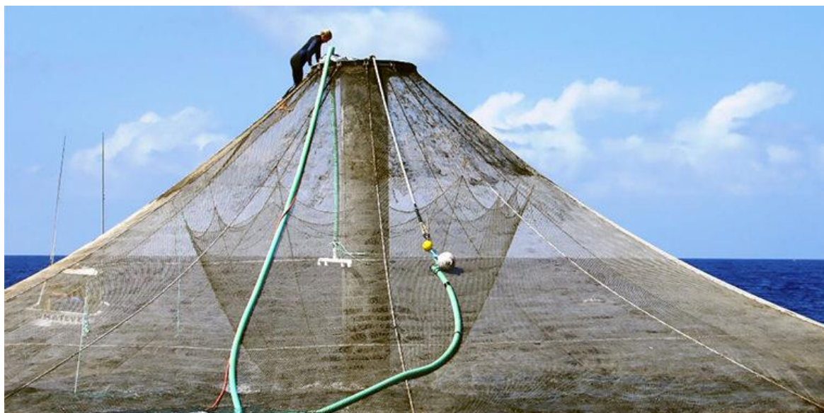
Figura 55 – Sistema de alimentação incluído numa jaula de aquacultura (Cashion et al. 2017).
