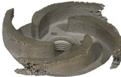
Figura 82 – Exemplo de equipamento danificado pelo efeito da cavitação (“Cavitação Em Bombas - Pesquisa Google” 2015).
