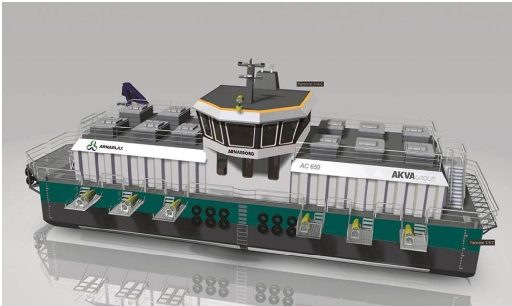
Figura 53 – Plataforma de controlo de alimentação com silos incluídos e sistemas de bombagem (“Huge Feed Barge to Iceland - AKVA Group 2018” 2018).
