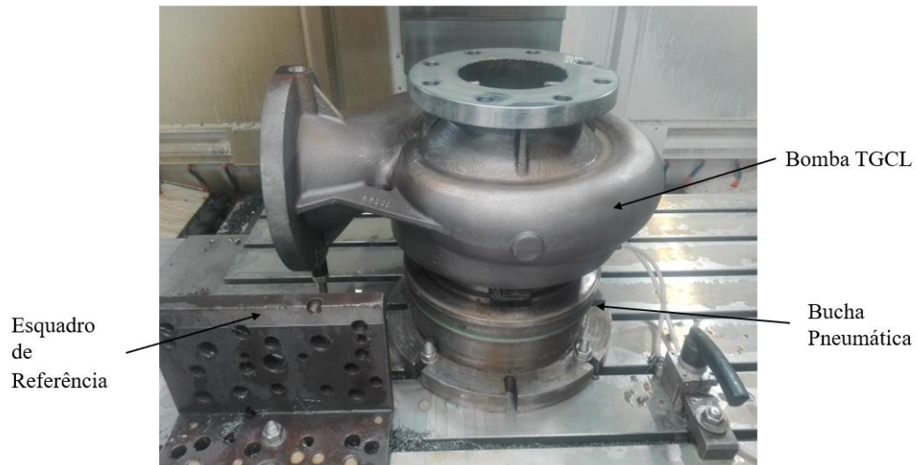
Figura 3.2 Componentes de fixação na 1ª fase de maquinagem do corpo da bomba.
