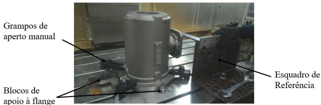
Figura A. 12 Dispositivos de fixação na segunda fase de maquinagem – CM Akira-Seiki.
