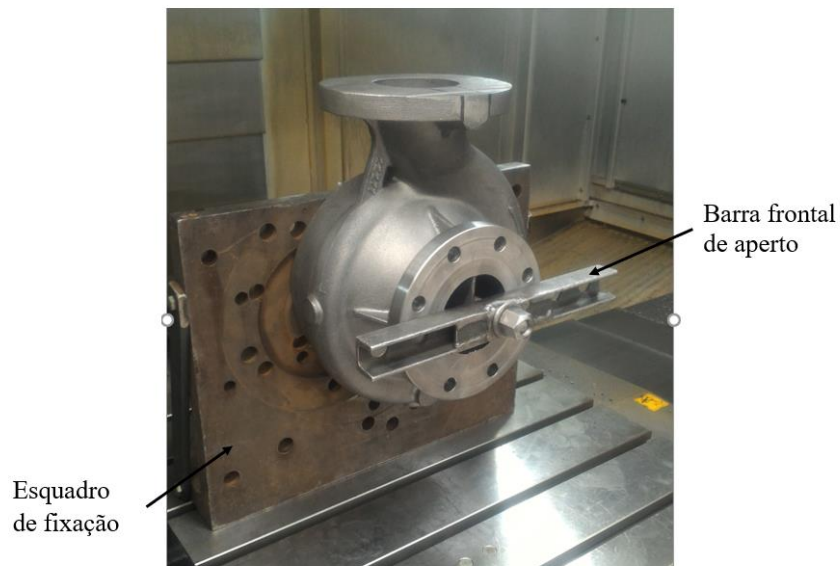
Figura A. 6 Elementos de fixação na terceira fase de maquinagem.
