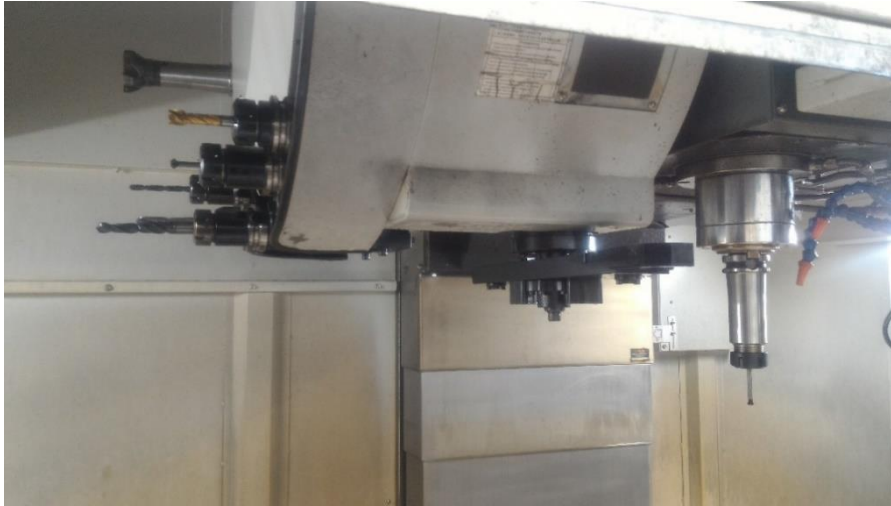
Figura 2.6 Sistema de mudança de ferramentas Akira-Seiki.
