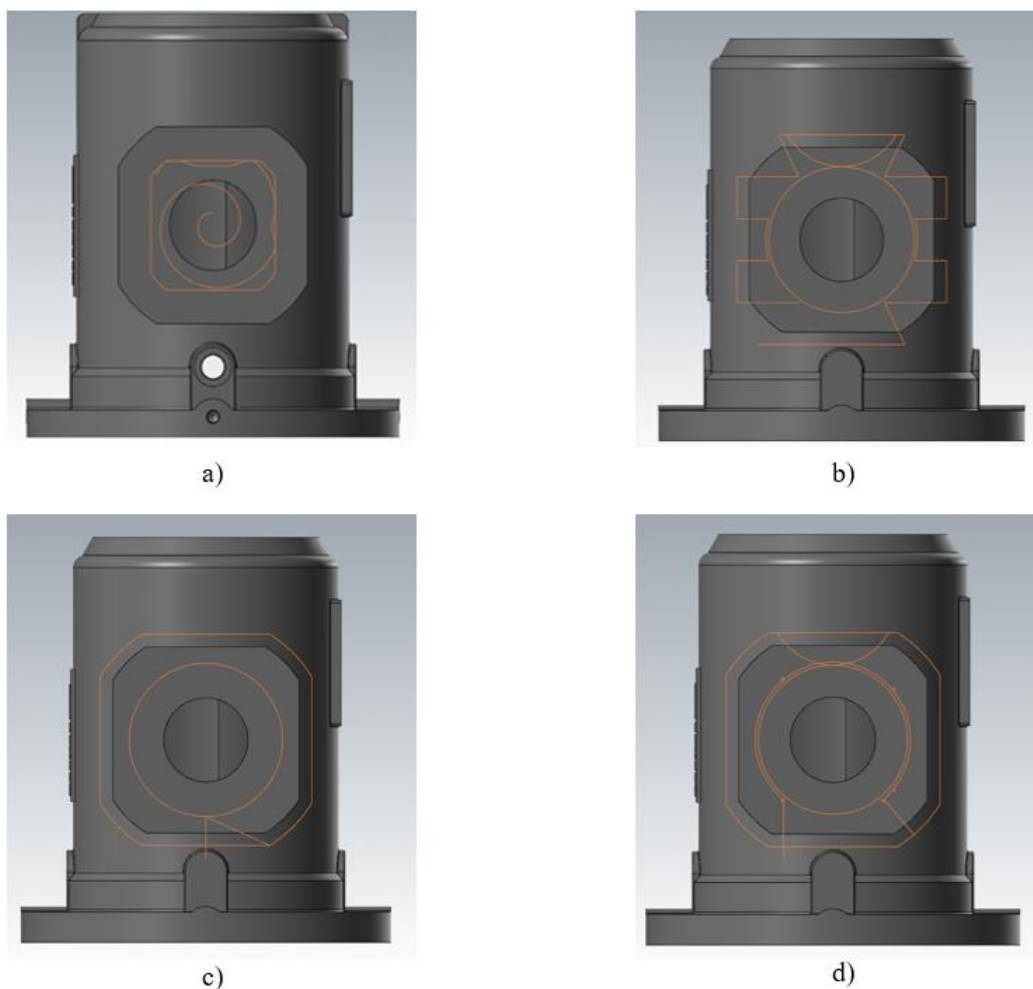
Figura C. 7 Ciclos de facejamento aplicado à zona da caixa de terminais da carcaça: a) Dinamic Mill; b) Zig-Zag; c) True Spiral; d) Morph Spiral.
