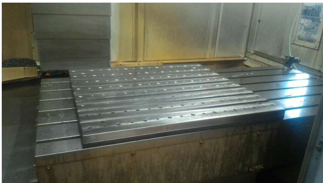
Figura 4.4 Mesa de fixação no centro de maquinagem Akira-Seiki .
