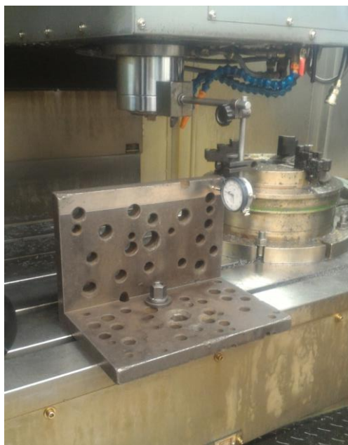
Figura 3.4 Alinhamento do esquadro com um comparador.
