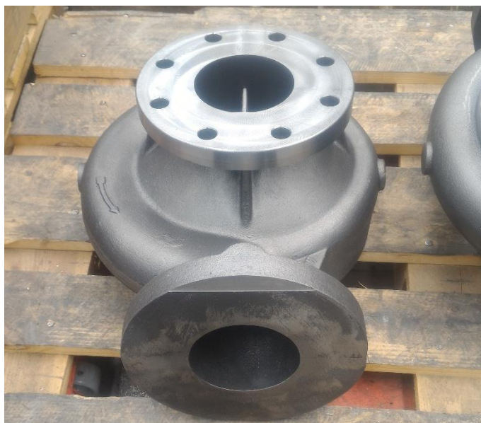
Figura 4.5 Furações de diâmetro 18 mm na flange de aspiração - Primeira fase de maquinagem.
