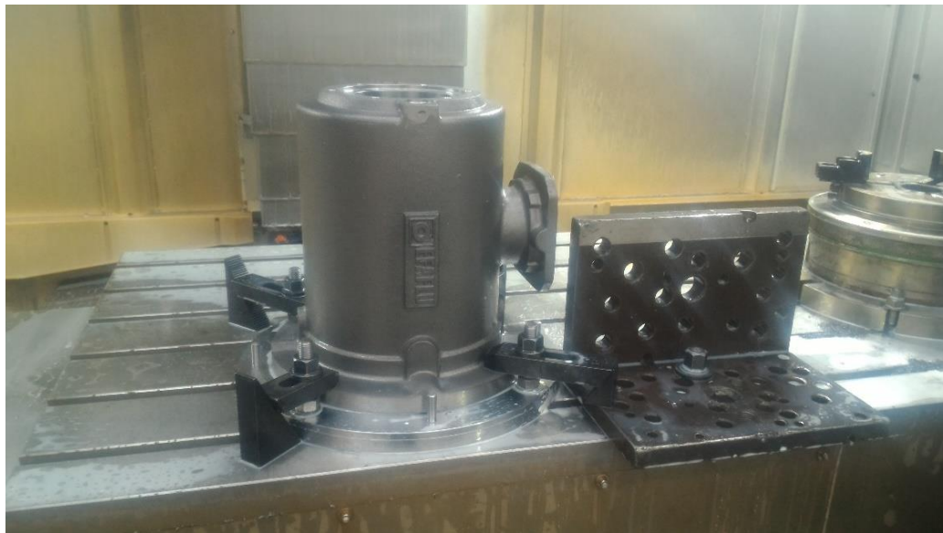
Figura 4.14 Implementação do prato de apoio às carcaças.
