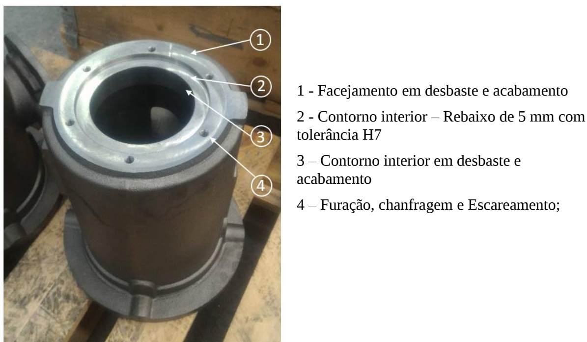
Figura A. 13 Operações de maquinagem na segunda fase no CM Akira-Seiki.
