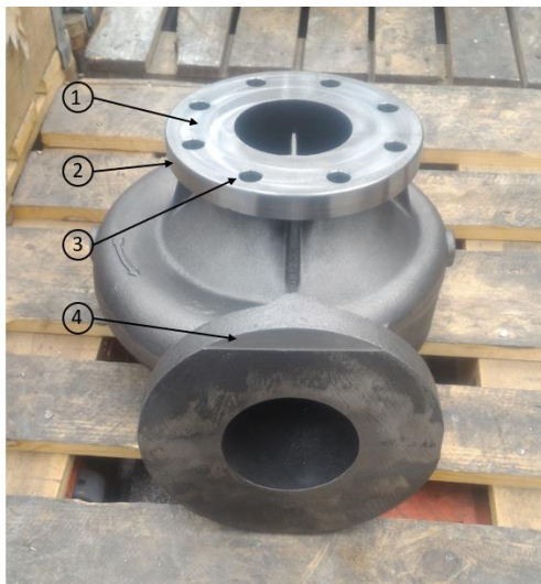
Figura A. 3 Operações de maquinagem na primeira fase.
