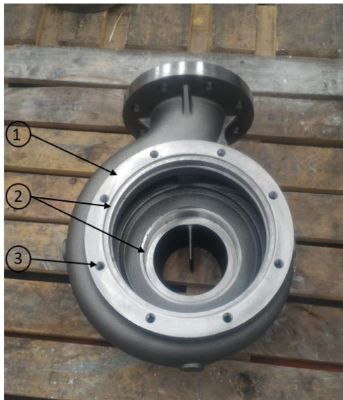
Figura A. 5 Operações de maquinagem na segunda fase - corpo da bomba TGCL100L.
