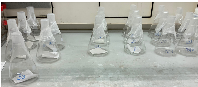
Figura 3-1: Fotografia das amostras têxteis colocadas no interior dos matrizes, convenientemente vedados, para posterior análise em GC-FID.
