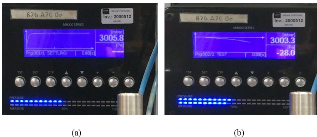
Figura 25 - Fase de enchimento e estabilização (a) e fase de medição (b) do teste de estanquidade
