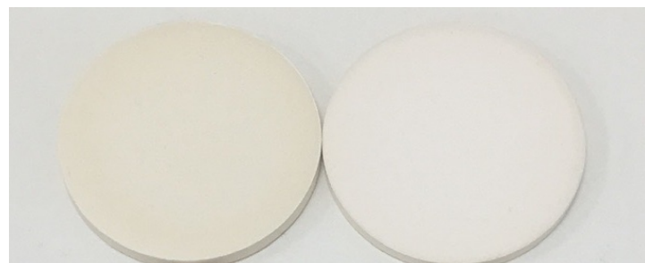
Figura 25. Registro fotográfico, realizado após um período de exposição de 7 dias, da (esquerda para a direita): face exposta e face oposta das medalhas com um t; de 24 horas imersas na solução de chocolate.
