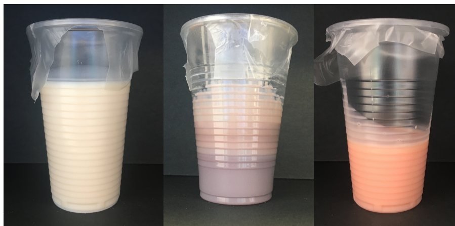
Figura 31. Registo fotográfico da cor (da esquerda para a direita): inicial de todas as misturas verniz:suspensão, da mistura verniz:baunilha e da mistura verniz:maçã ao fim de alguns dias.
