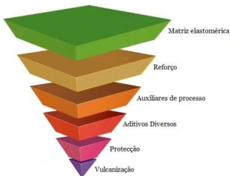
Figura 2.4 - Sistema elastomérico e correspondentes subsistemas, adaptada de [22].
