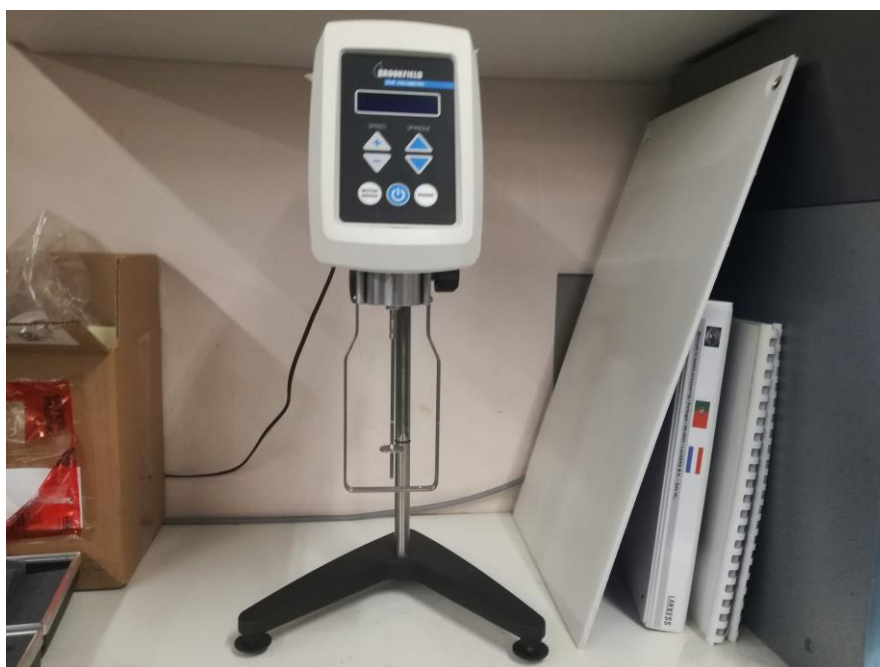
Figura A. 6 - Equipamento utilizado na medição da viscosidade, Brookfield DVE Viscosimeter.
