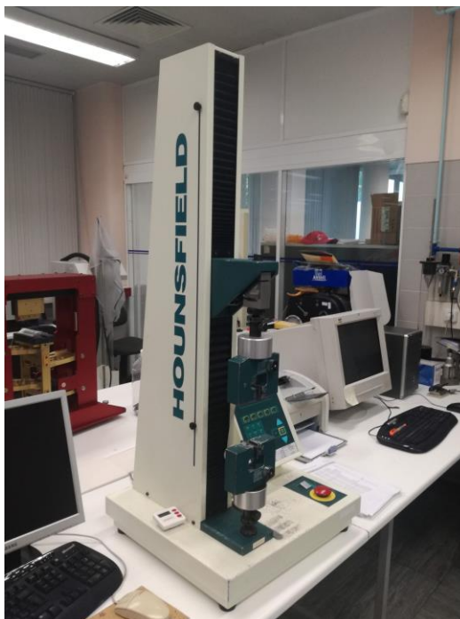
Figura A. 12 - Equipamento utilizado nos ensaios de resistência à perfuração e ao rasgo, Hounsfield.
