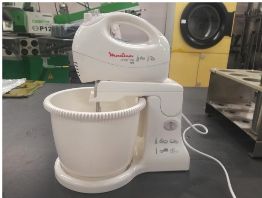
Figura A. 2 - Equipamento utilizado para a incorporação de ar na formulação, Moulinex prep'line 450 W.
