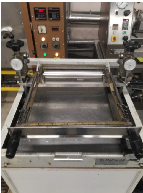
Figura A. 3 - Equipamento utilizado para o revestimento do substrato têxtil, Coating Device Type SV Werner Mathis AG.
