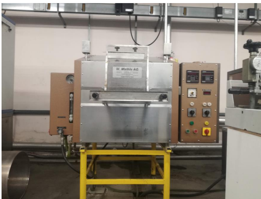
Figura A. 4 -Secadeira LTE Werner Mathis AG utilizada para secagem e cura das amostras.
