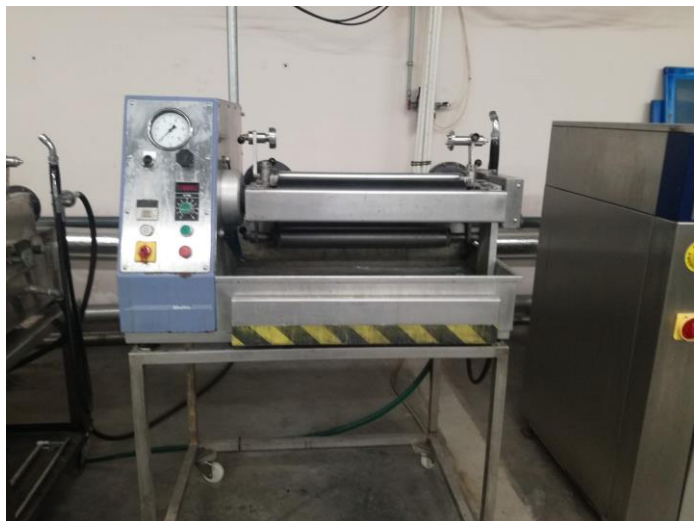
Figura A. 1 - Equipamento utilizado para impregnar as soluções no substrato têxtil, Werner Mathis HVF Type.
