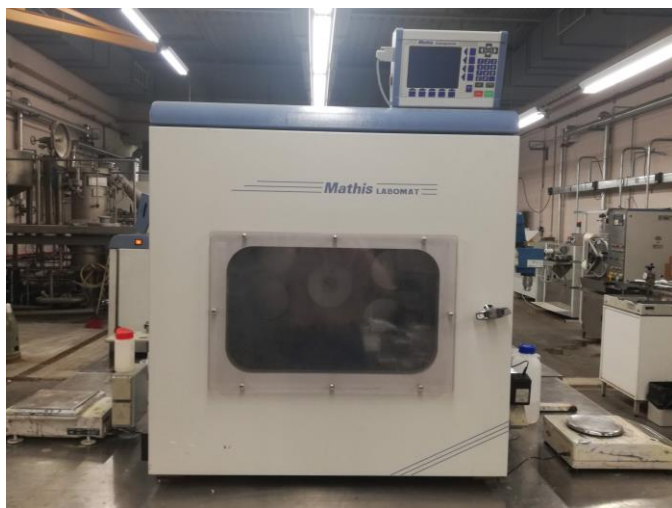
Figura A. 8 -Equipamento utilizado para a realização de ensaios de solidez à lavagem, Labomat Werner Mathis AG.
