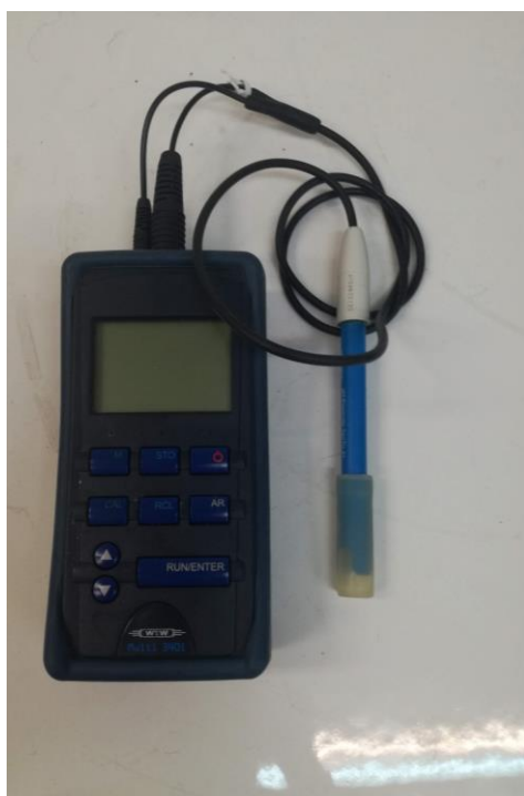
Figura A. 7 - Equipamento utilizado na medição do pH, WTW Multi 340i.
