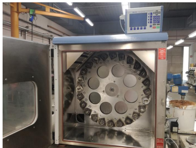
Figura A. 8 -Equipamento utilizado para a realização de ensaios de solidez à lavagem, Labomat Werner Mathis AG.
