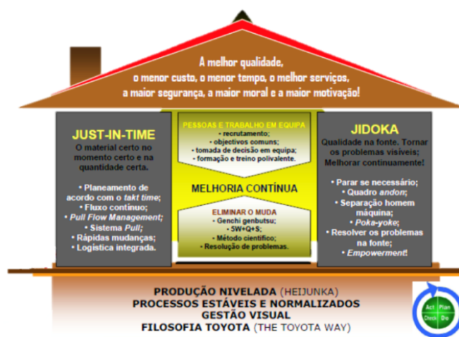
Figura 2 – Estrutura do sistema de produção da Toyota, a casa do TPS (Fonte: Pinto, 2009).
