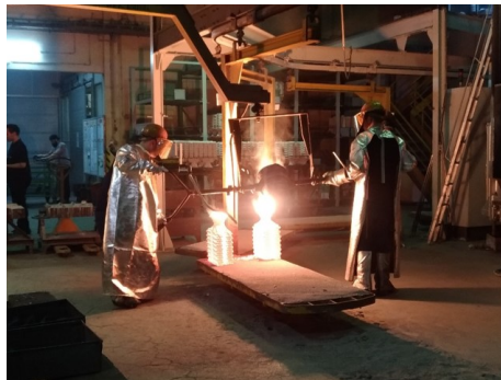
Figura 2.6: Vazamento por gravidade
