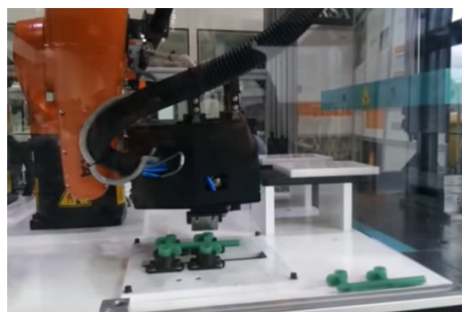
Figura 2.20: Corte dos canais[18]
