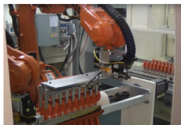
Figura 2.29: Barra quente derrete peças e gitagem [20]
