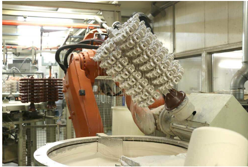
Figura 2.5: Mergulho no revestimento cerâmico [10]
