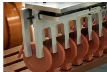
Figura 2.30: Aproximação das peças à gitagem [20]
