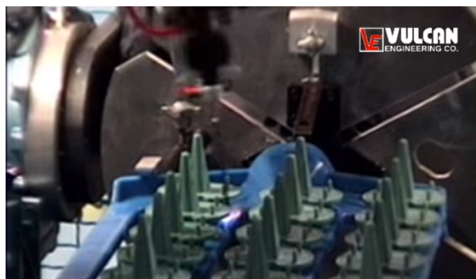
Figura 2.34: Colagem das peças recorrendo a tocha de gás [22]
