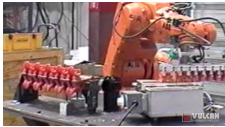
Figura 2.31: Mergulho em cera colado lado esquerdo [21]
