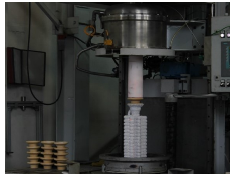
Figura 2.7: vazamento em vácuo
