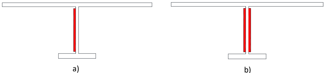
Figura 37 – Representação da aplicação de reforço FRP simples (a) e duplo (b)
