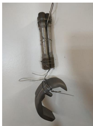
Figura 17- Método de fixação das amostras e dos provetes.
