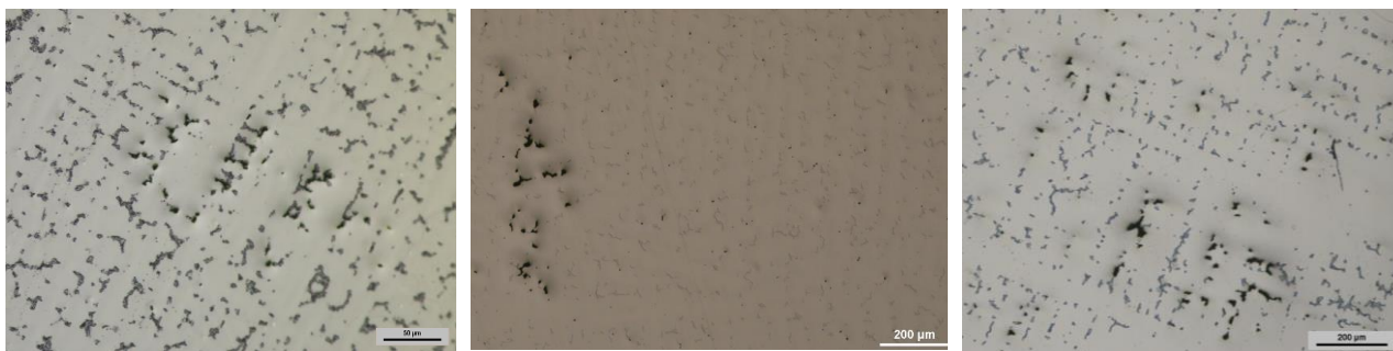
Figura 51- Microcavidades localizadas na continuidade dos carbonetos.
