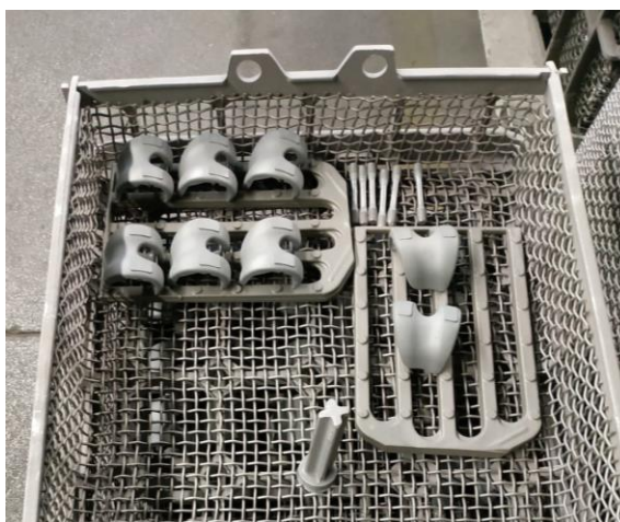
Figura 18- Disposição da carga nos cestos para tratamento térmico.
