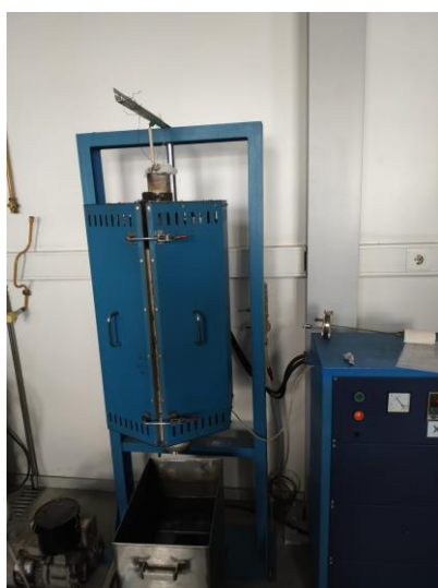
Figura 16- Forno de mufla do DEMM utilizado para a realização dos tratamentos térmicos.
