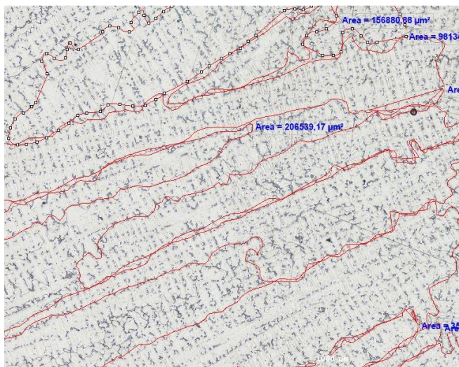
Figura 36- Microestrutura característica das zonas 1 e 2, constituída por grãos alongados.
