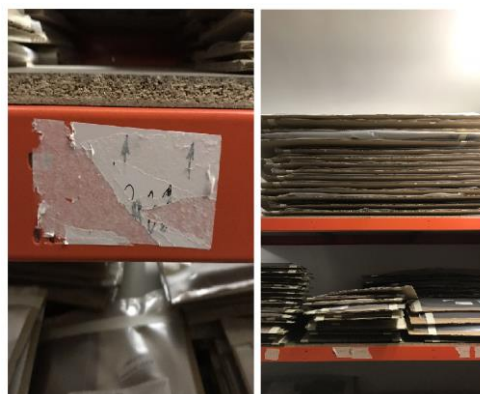
Figura 11 - Ilegibilidade (à esquerda) e inexistência (à direita) de identificações nas estantes de armazenamento de núcleos.
