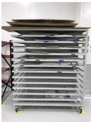
Figura 25 - Identificações magnéticas dos part numbers presentes no supermercado de núcleos da sala limpa.
