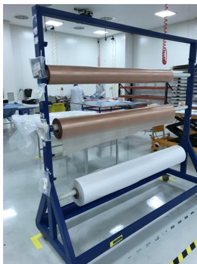
Figura 26 - Identificações das referências colocadas na estrutura de suporte de rolos.
