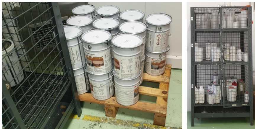
Figura 17 - Inexistência de identificações e armazenamento incorreto de materiais de pintura.
