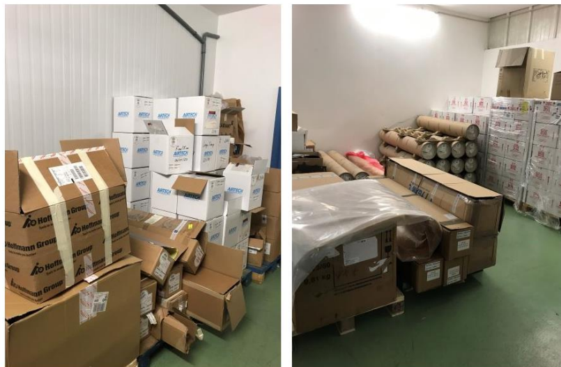
Figura 15 - Problemas de insuficiência de estruturas para armazenar materiais auxiliares e de inexistência de identificações para as suas localizações.
