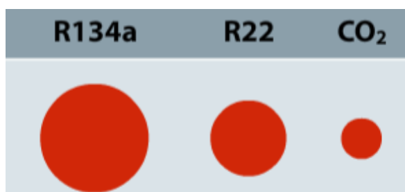
Figura 6 – Comparação relativa da secção de tubagem para diferentes fluidos frigoríficos para a mesma capacidade frigorífica.
