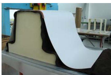
Figura 9.12 Molde com revestimento e termoplástico
