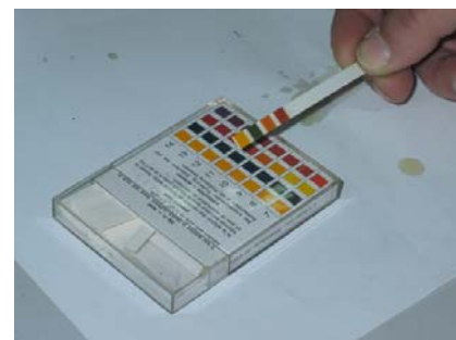
Figura 5.10 Medição do PH do endurecedor
