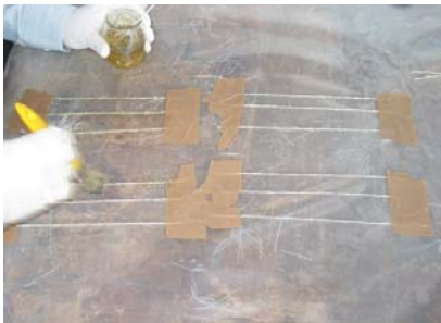
Figura 5.12 Impregnação dos fios com resina
