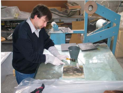
Figura 5.1 Execução do compósito reforçado com tecido
