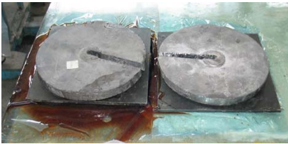
Figura 5.2 Compósito sob pressão de um peso
