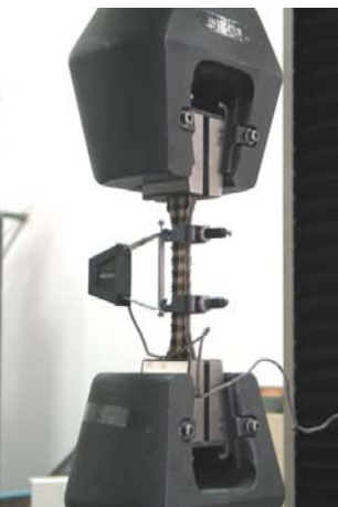
Figura 8.3 Ensaio de tracção de um provete em lâ-epoxy revestido
