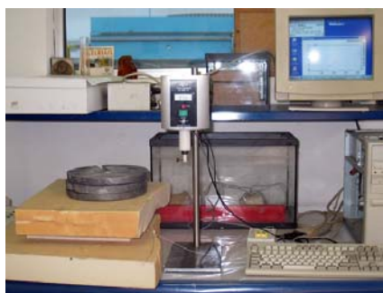
Figura 6.9 Medição da temperatura de um laminado isolado
