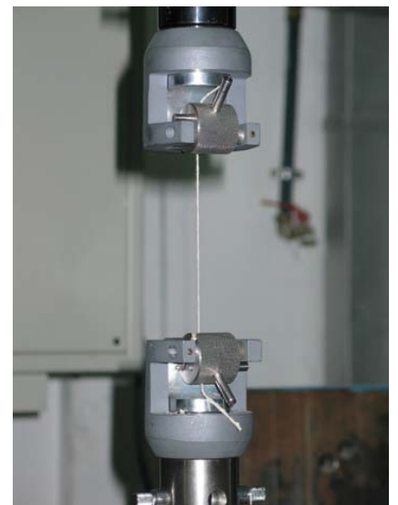
Figura 5.14 Ensaio de tracção dos fios
