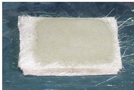
Figura 6.4 Placa de compósito com termopar
