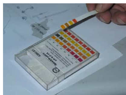
Figura 5.11 Medição do PH da resina
