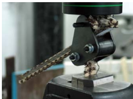
Figura 8.5 Ensaio de arrancamento
