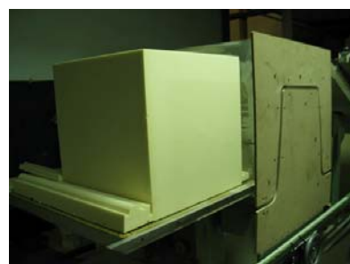
Figura 9.7 Bloco e matriz na máquina de corte
