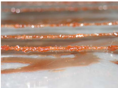
Figura 5.13 Fios impregnados com resina epoxy
