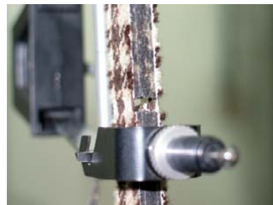
Figura 8.4 Rotura de um provete revestido
