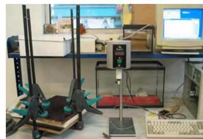
Figura 6.6 Medição de temperatura numa placa isolada
