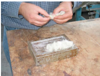
Figura 5.4 Colocação das fibras no molde
