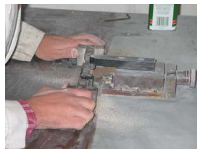
Figura 5.6 Corte dos provetes de tracção
