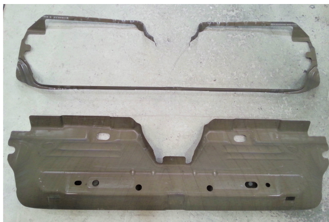
Figura 4.1: Peça produzida e respetivo material excedente antes da reprogramação do equipamento de corte.
