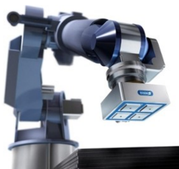
Figura 2.20: Exemplo de uma garra magnética (Bernier, 2014).
