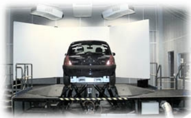
Figura 24. O simulador de condução de base móvel da Renault
