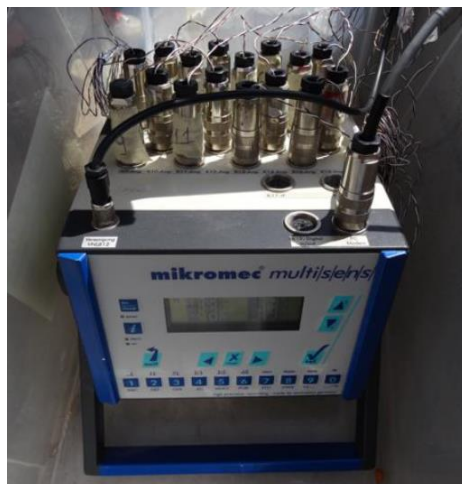
Figura 25 - Datalogger Mikromec Logger Multisens com termopares ligados, fonte (Sá, 2017)
