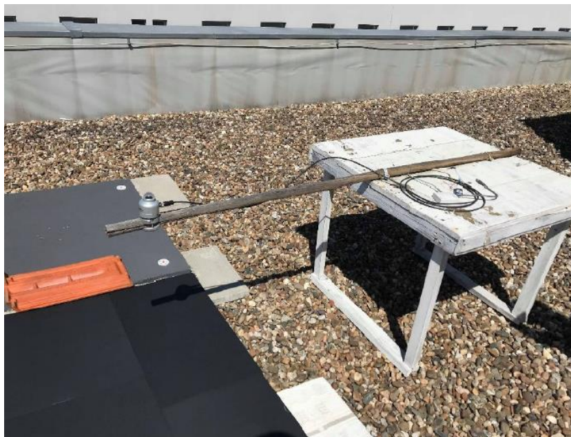
Figura 21 - Medição de irradiância de máscara preta com piranómetro, fonte (Sá, 2018)
