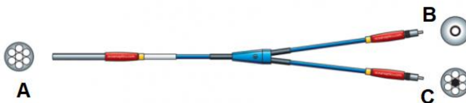
Figura 14 - Sonda de fibra ótica - A - Entrada de luz refletida e saída de luz incidente; B - Entrada de luz da fonte de iluminação; C - Saída de luz refletida para o espectrofotómetro (Optics, 2019c)
