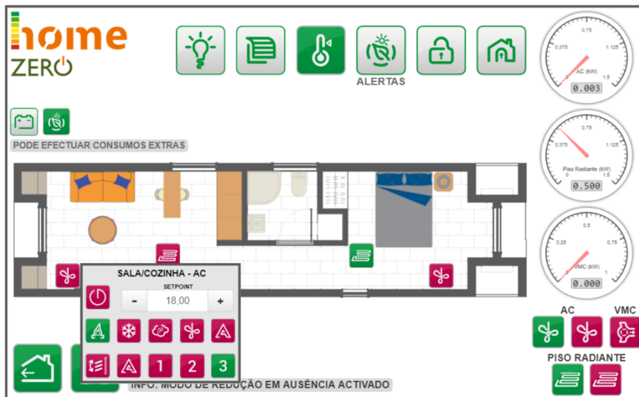
Fig. 41 - Painel de controlo da Climatização do protótipo.
