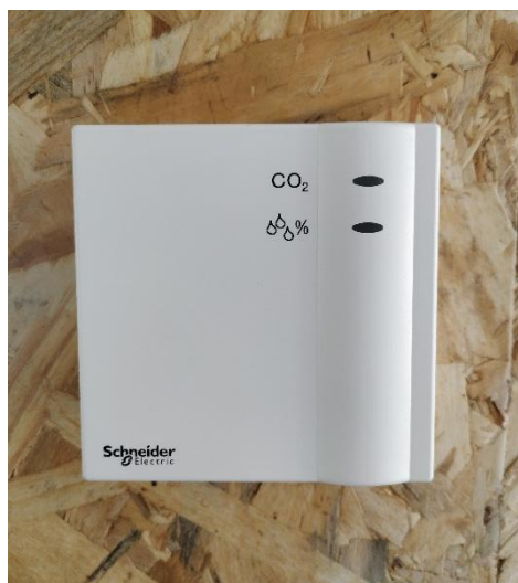
Fig. 31 - Sensor de CO 2 , temperatura e humidade do protótipo (Schneider Electric).
