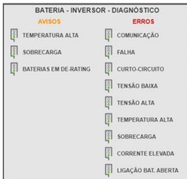
Fig. 47 - Diagnóstico do inversor da Bateria do protótipo em tempo real.
