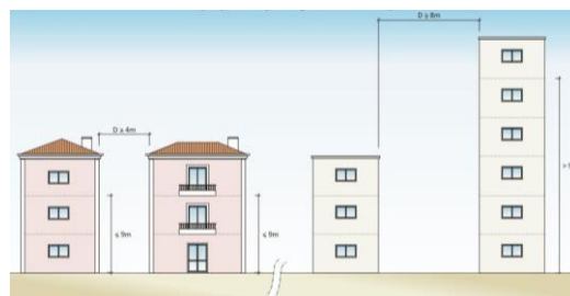
Fig. 3.4 – Propagação do incêndio através de edifícios adjacentes, [42]
