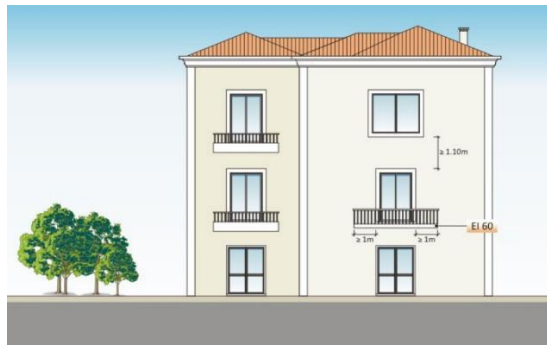
Fig. 3.2 – Propagação do incêndio através de vãos, [42]
