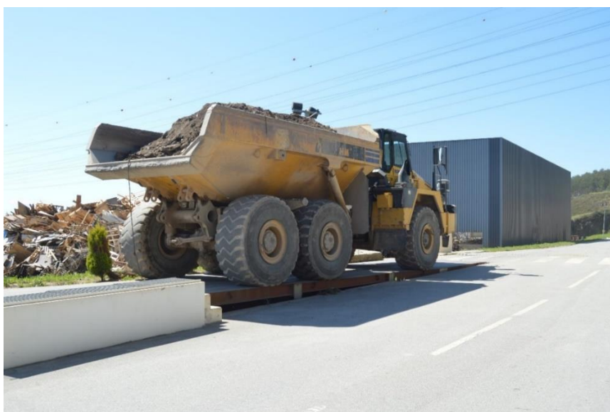
Figura 10 – Camião Estaleiro (Dumper grande) a ser pesado na báscula da Recivalongo
