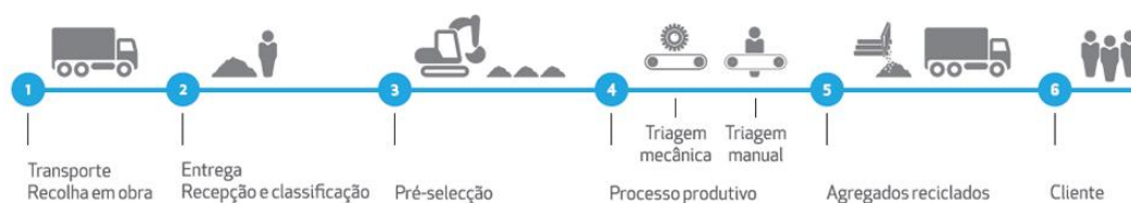
Figura 4 – Processo de transformação de RCD em agregado reciclado, imagem RCD – Resíduos de Construção e de Demolição, S.A.
