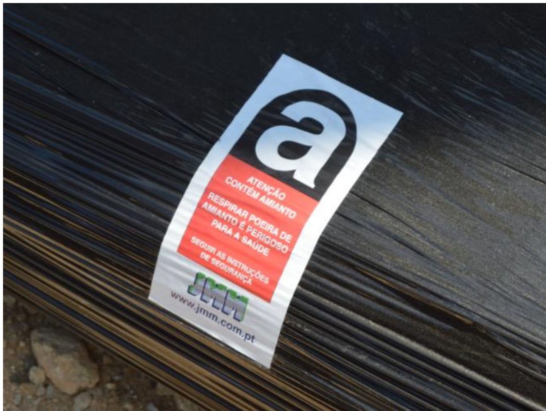
Figura 3 – Etiqueta alertando de que o material envolvido na película contém amianto
