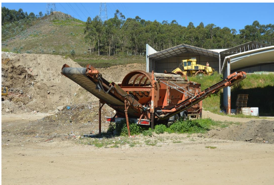
Figura 12 – Trommel móvel pertencente à Retria
