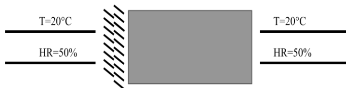
Figura 19 – Ilustração esquemática das condições de temperatura e humidade relativa para o betão
