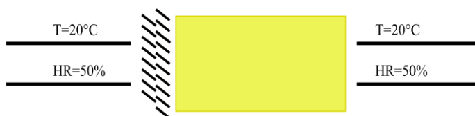
Figura 16 – Ilustração esquemática das condições de temperatura e humidade relativa para a pedra calcária
