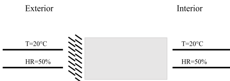
Figura 15 – Ilustração esquemática das condições iniciais de Temperatura e Humidade Relativa consideradas
