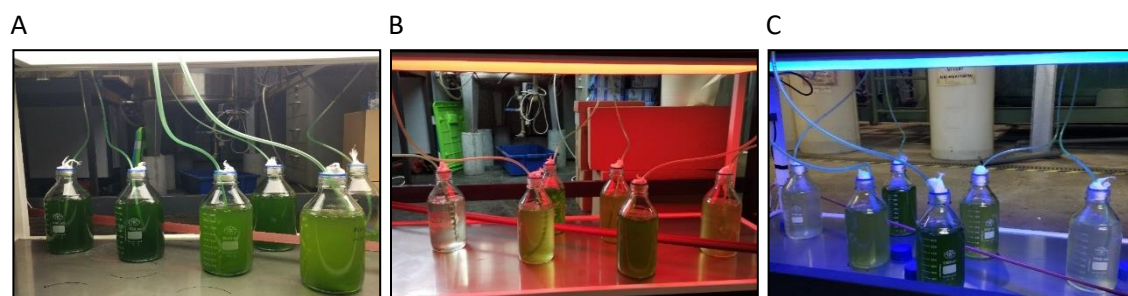
Figura 4 – Instalação experimental usada para o crescimento das microalgas com LEDs de diferentes cores: A. LED branco (380-750 nm); B. LED vermelho (620-750 nm); C. LED azul (450-495 nm).
