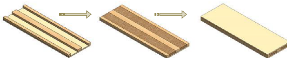
Figura 3.6: Processo de Construção do Painel (Tiago Pereira, 2014, Implementação de técnicas e princípios Lean numa empresa de mobiliário , Guimarães: Universidade do Minho, 35).
