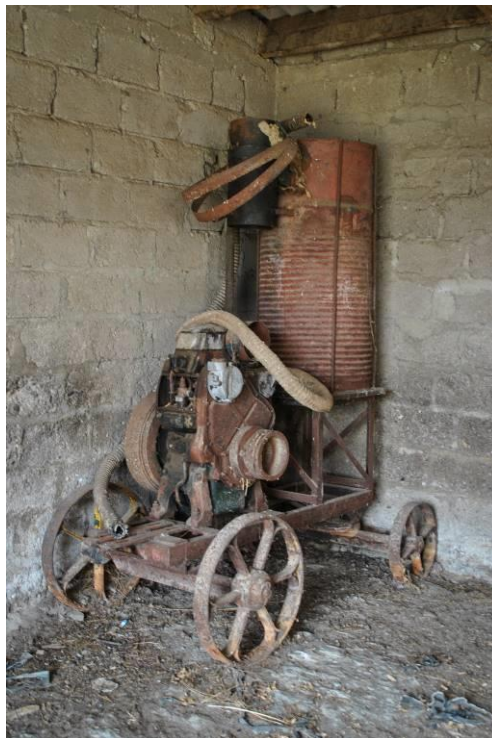
Fotografia 36: Motor de combustão para a malhadeira da Quinta Branca
