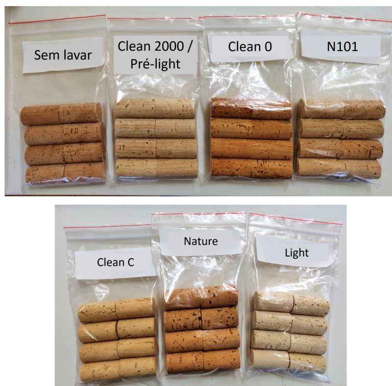
Figura 3.3: Lavações e Revestimentos existentes na UI VL
