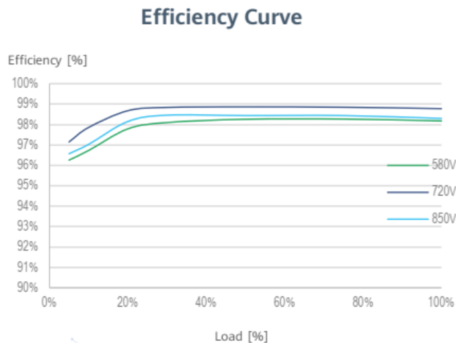
Figura 4.7 - Curva de eficiência do inversor utilizado.
