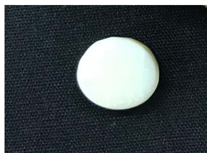
Figura 3 - Disco restaurado com uma camada de 1mm de resina composta
