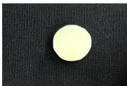
Figura 4 - Disco de esmalte/dentina após seccionamento de dente bovino
