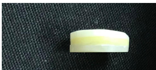
Figura 5 - Disco Final diferenciado nas três camadas de esmalte, dentina e resina composta
